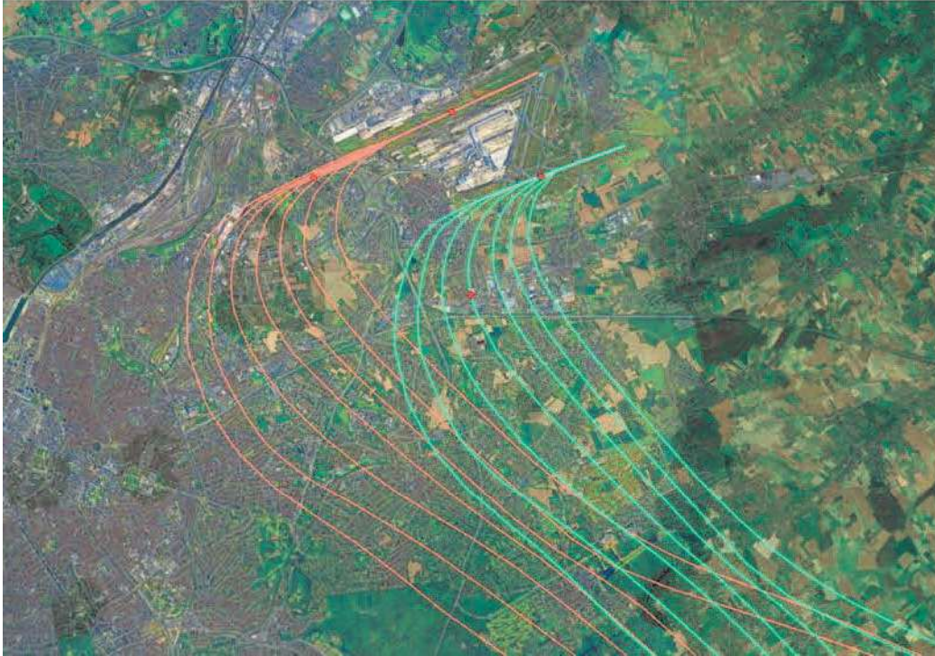
Figure 81 : Backbone track et subtracks déplacées sur la piste 25L avec les altitudes pour un virage à 700 ft
